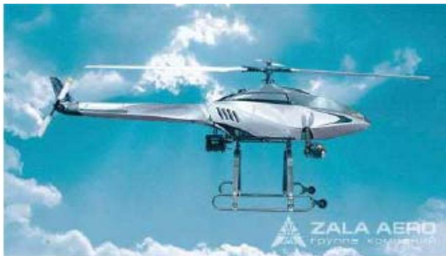
Рисунок 1. Беспилотный летательный аппарат ZALA 421-02X
