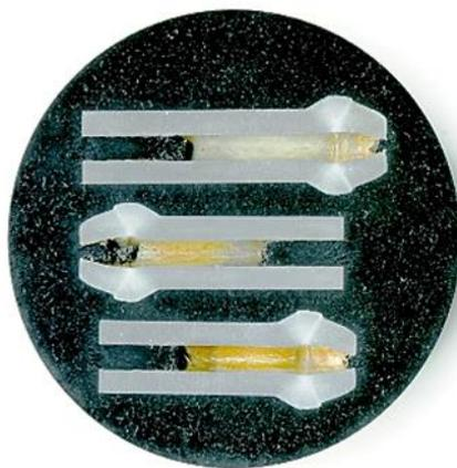
Рис. 5. Изменение формы отверстия при высадке конца трубы
