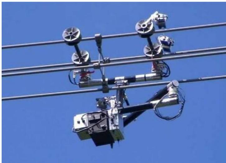
Рис. 1. Робот для обслуживания ЛЭП
