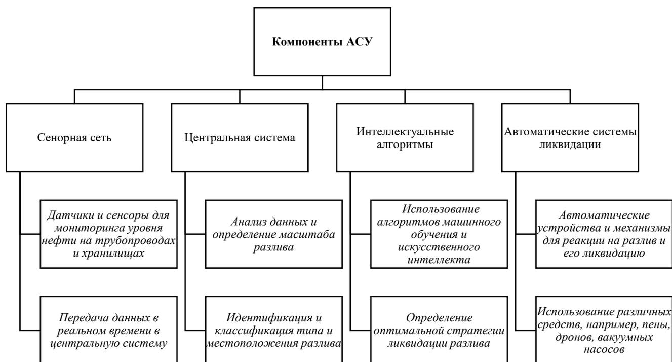
Рис. 1. Основные компоненты автоматизированной системы управления идентификацией и ликвидацией разливов нефти
