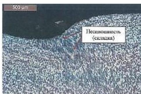
Рис. 6. Складки на внутренней поверхности высаженных концов ТВД
