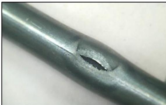
Рис. 7. Лопнувшая трубка ТВД
