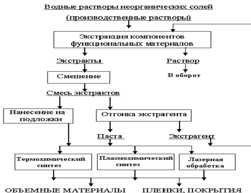
Рис. 5. Порядок получения наноматериала экстракционно-пиролитическим методом [3]
