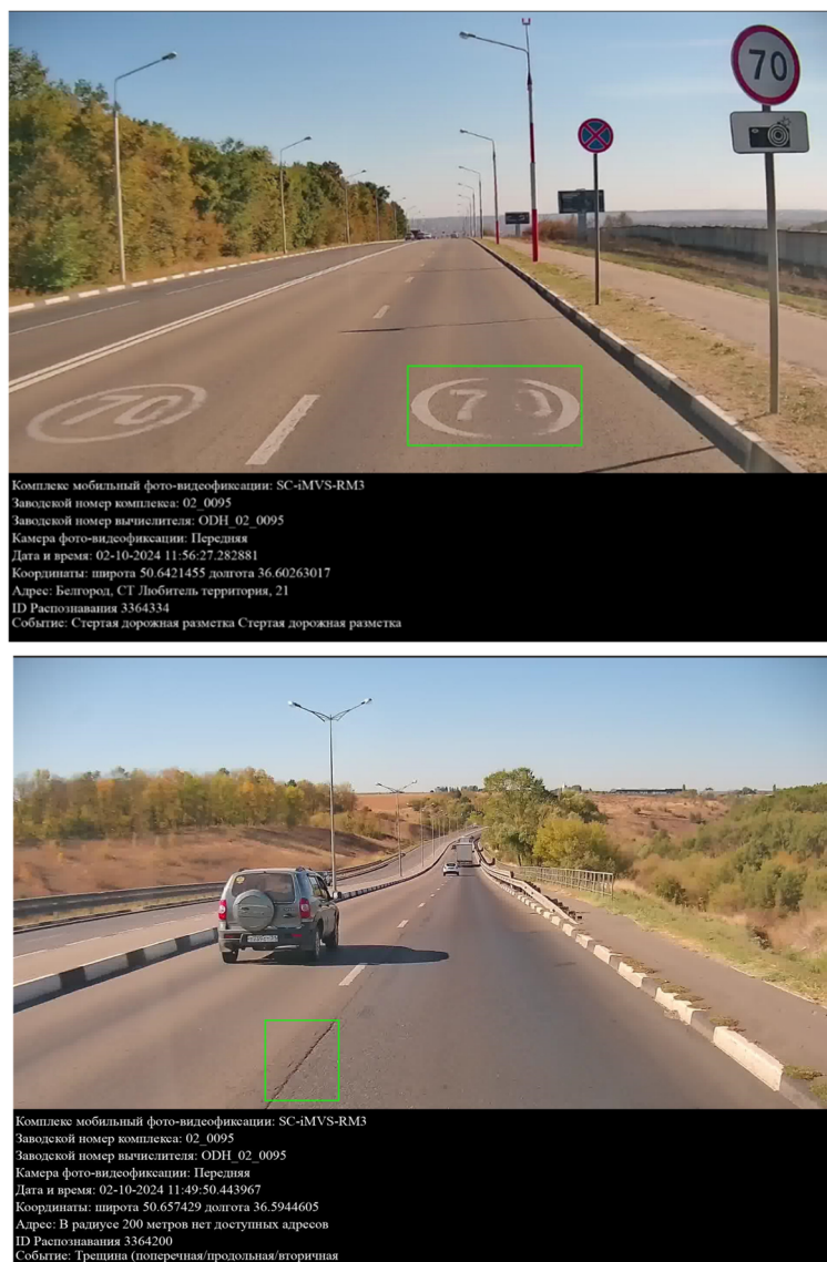
Рис. 2. Пример работы комплекса по контролю состояния покрытия автомобильной дороги [1]
