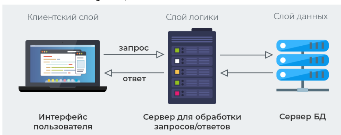
Рис. 2. Схема взаимодействия слоев в веб приложении [2]
