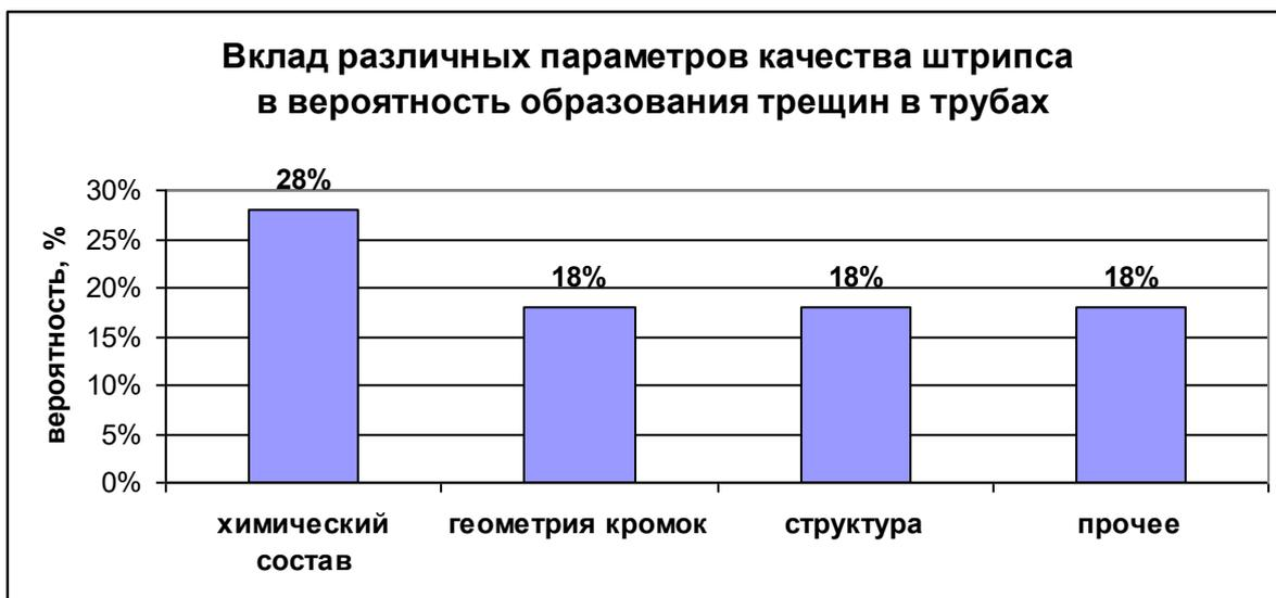
Рис. 31 Оценка вклада различных параметров качества штрипса в вероятность образования трещин в трубах
