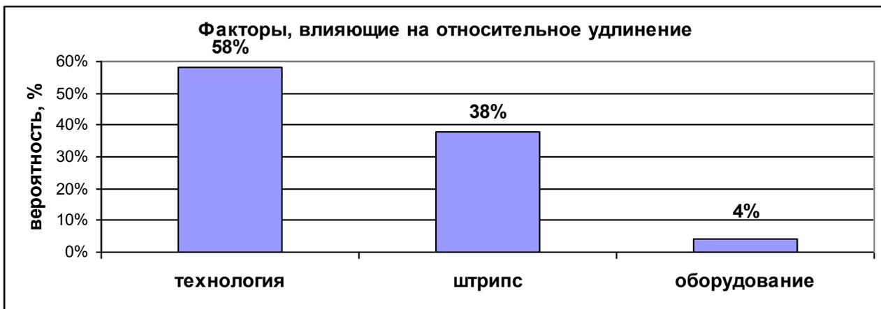
Рис. 37 Значение различных факторов на величину относительного удлинения при растяжении образцов труб
