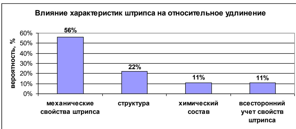
Рис. 39 Степень влияния характеристик качества штрипса на величину относительного удлинения при растяжении образцов труб
