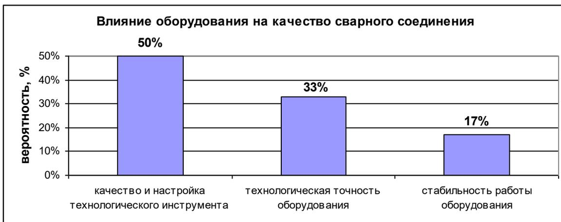
Рис. 51 Степень влияния характеристик оборудования на качество сварного соединения
