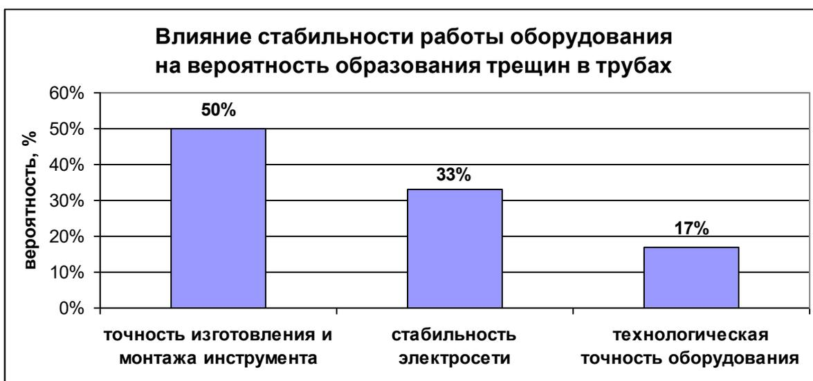
Рис. 32 Оценка влияния параметров стабильности оборудования на вероятность образования трещин в трубах
