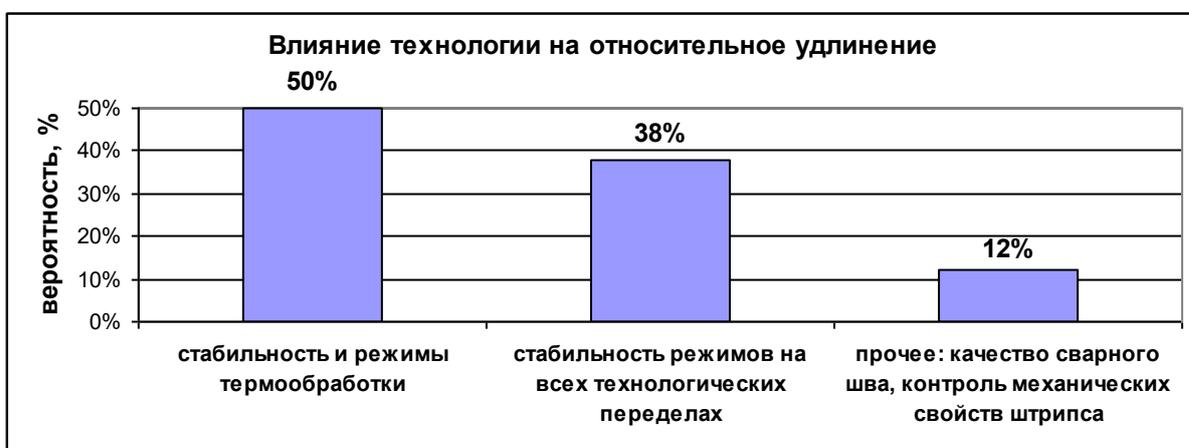
Рис. 38 Степень влияния технологических параметров на величину относительного удлинения при растяжении образцов труб
