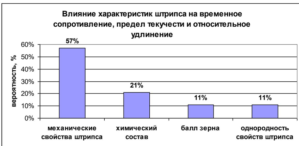
Рис. 48 Значимость параметров качества штрипса, влияющих на величины характеристик механических свойств материала трубы
