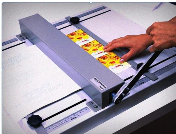
Рисунок 39 – Ручная биговальная машина ударного типа
