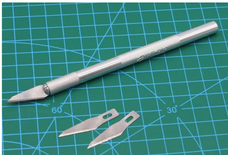
Рисунок 49 – Макетный нож со съёмными насадками и макетная доска
