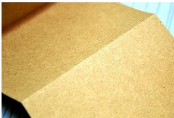
Рисунок 37 – Биговка на плотном картоне
