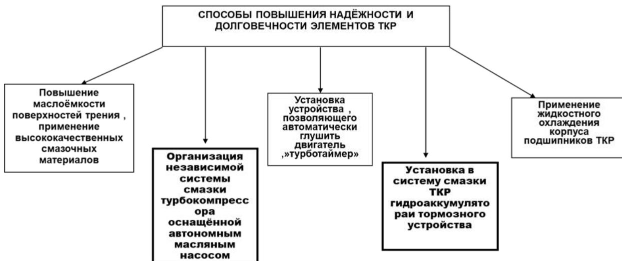
Рисунок 1.11 – Основные способы и направления повышения надежности и долговечности элементов ТКР
