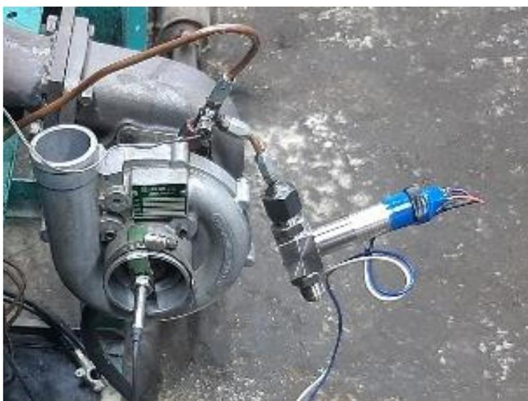
Рисунок 3.15 – Компактный датчик дифференциального давления APZ 3020
