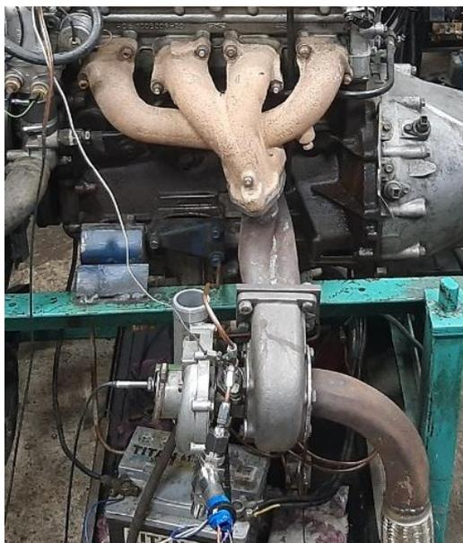
Рисунок 3.4 – Турбокомпрессор K27-145 чешского производства, питаемый выхлопными газами от двигателя ЗМЗ-4062
