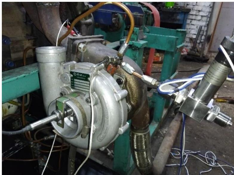
Рисунок 3.16 – Тройной разветвитель с подсоединенными к нему: 1. сверху в него приходит масло от маслостанции или гидроаккумулятора; 2. сбоку присоединен через штуцер датчик дифференциального давления APZ 3020; 3. фронтально к наблюдателю расположен штуцер с присоединенной к нему термопарой
