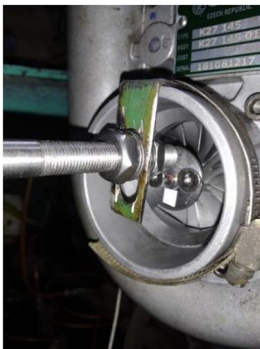
Рисунок 3.12 – Датчик, установленный на корпусе турбокомпрессора на струбцине
