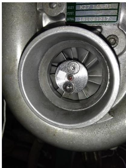
Рисунок 3.13 – Магнитная метка, размещенная на установочной шайбе
