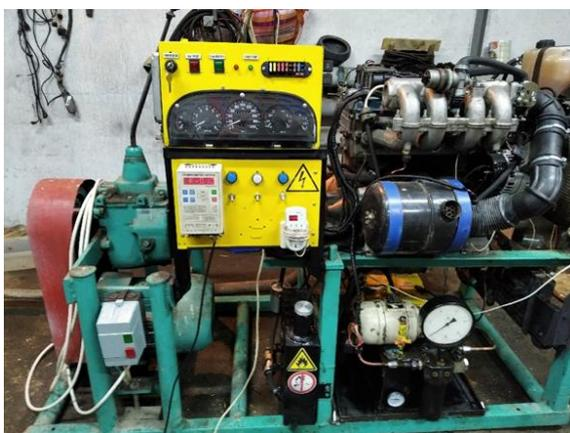
Рисунок 3.2 – Исследовательская установка на базе двигателя ЗМЗ-4062 с установленным на него турбокомпрессором K27-145 (Strakonice-Чехия)
