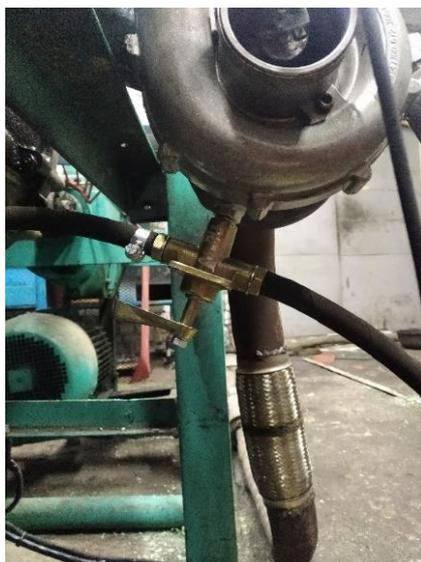
Рисунок 3.17 – Трехходовой кран с расходомером масла на сливе ТКР и термопарой для измерения мгновенной температуры масла на выходе из подшипника ТКР
