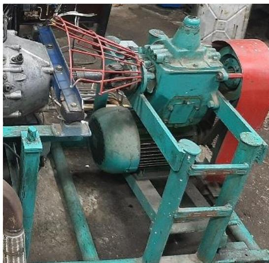
Рисунок 3.3 – Электродвигатель исследовательской установки мощностью 5,5 кВт соединенный посредством ременной передачи с 4-х ступенчатой коробкой передач ГАЗ-52
