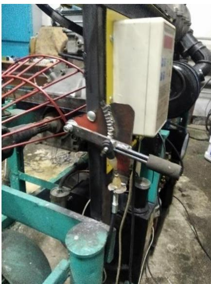
Рисунок 3.19 – Рычажное устройство с тонкой градацией установочного угла
