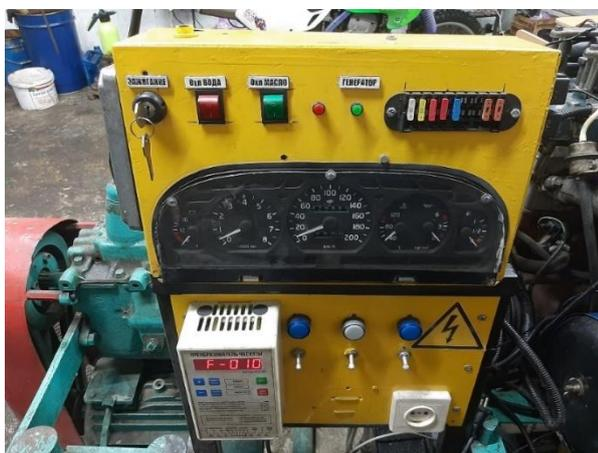
Рисунок 3.5 – Штатная система управления с щитком приборов, ЭБУ, блоком предохранителей и замком зажигания
